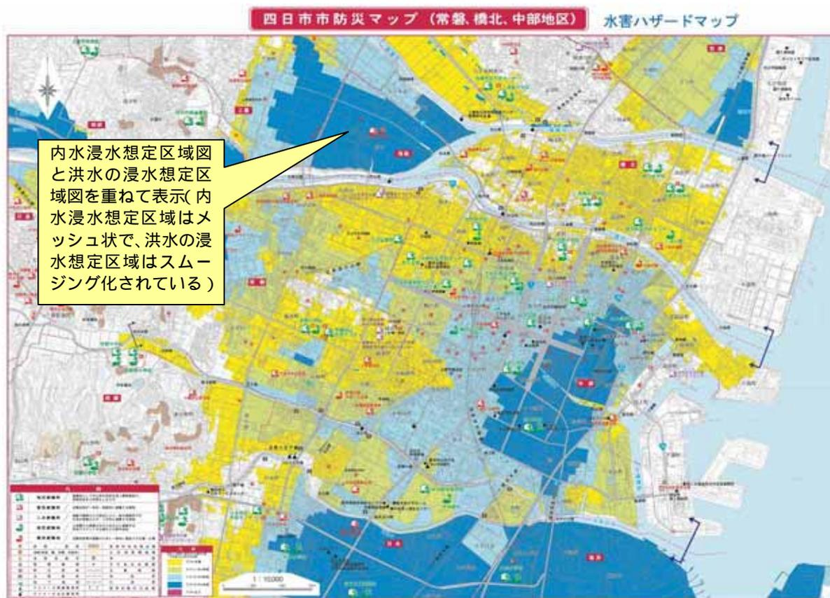
図4 - 6 (2/2) 内水と洪水の浸水想定区域図の複合表示の事例(裏面に内水と洪水の浸水想定区域図の重ね合わせ図)(出典：四日市防災マップ)
