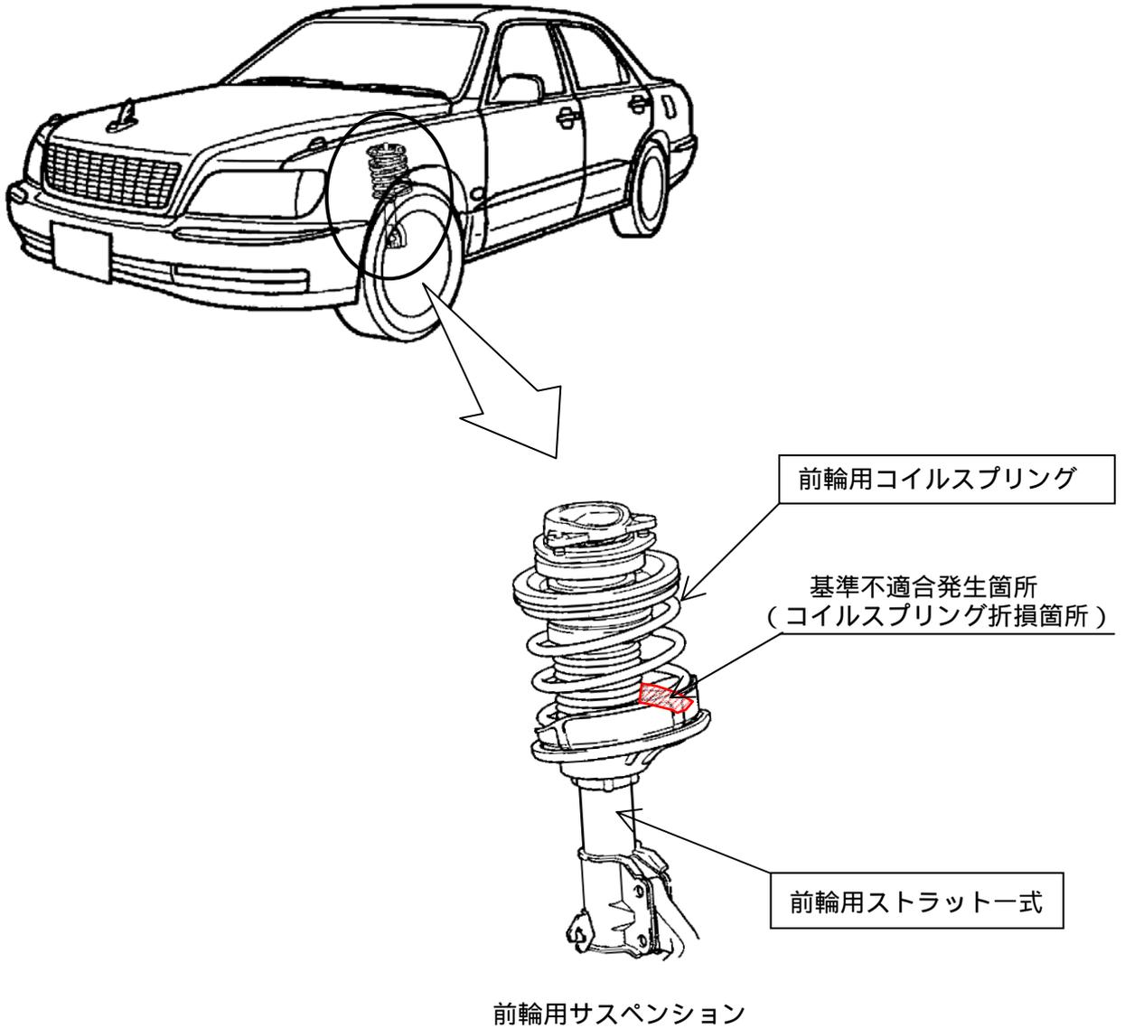
電子制御式サスペンション装着車において、前輪用コイルスプリングの形状が不適切なため、当該スプリングが線間で擦れた部分の塗膜が剥れて腐食することがある。そのため、そのまま使用を続けると、融雪剤等により腐食が進行してスプリングが折損し、最悪の場合、タイヤがパンクして走行不能となるおそれがある。
