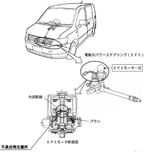
電動式パワーステアリング(EPS)のモータのブラシ材質とステアリングギヤ比の組み合わせが不適切なため、ハンドルが止まるまで据え切り操作を繰り返すと、モータの回転を均一にするための内部配線に大電流が流れる場合がある。そのため、当該配線が短絡してEPS警告灯が点灯するとともにハンドルの操作力が増大するおそれがある。
