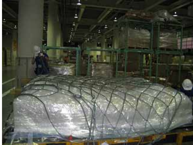
図 2-7 ULDビルドアップ(ネットイング)
