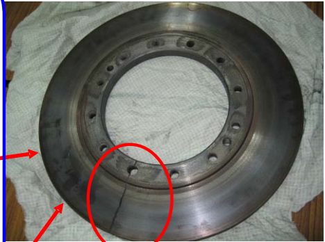
亀裂が発生したディスクロータ
