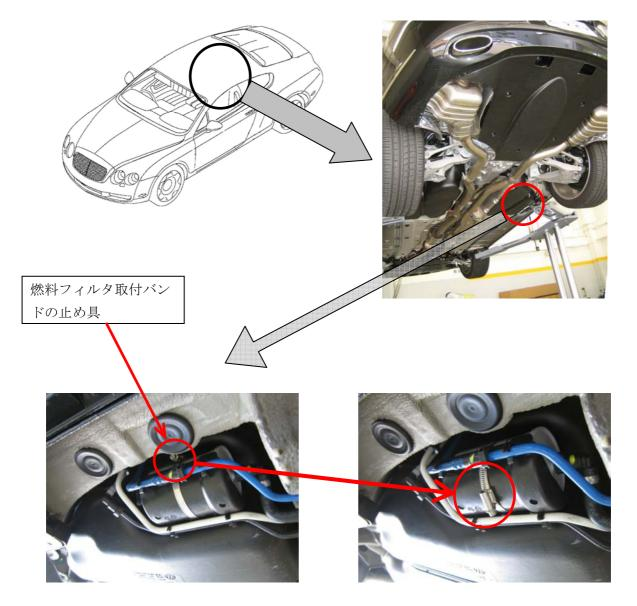
改良された燃料フィルタが取り付けられているが 取付バンドの止め具の位置が不適切なもの 改良された燃料フィルタが取り付けられ 取付バンドの止め具の位置を改善したもの
