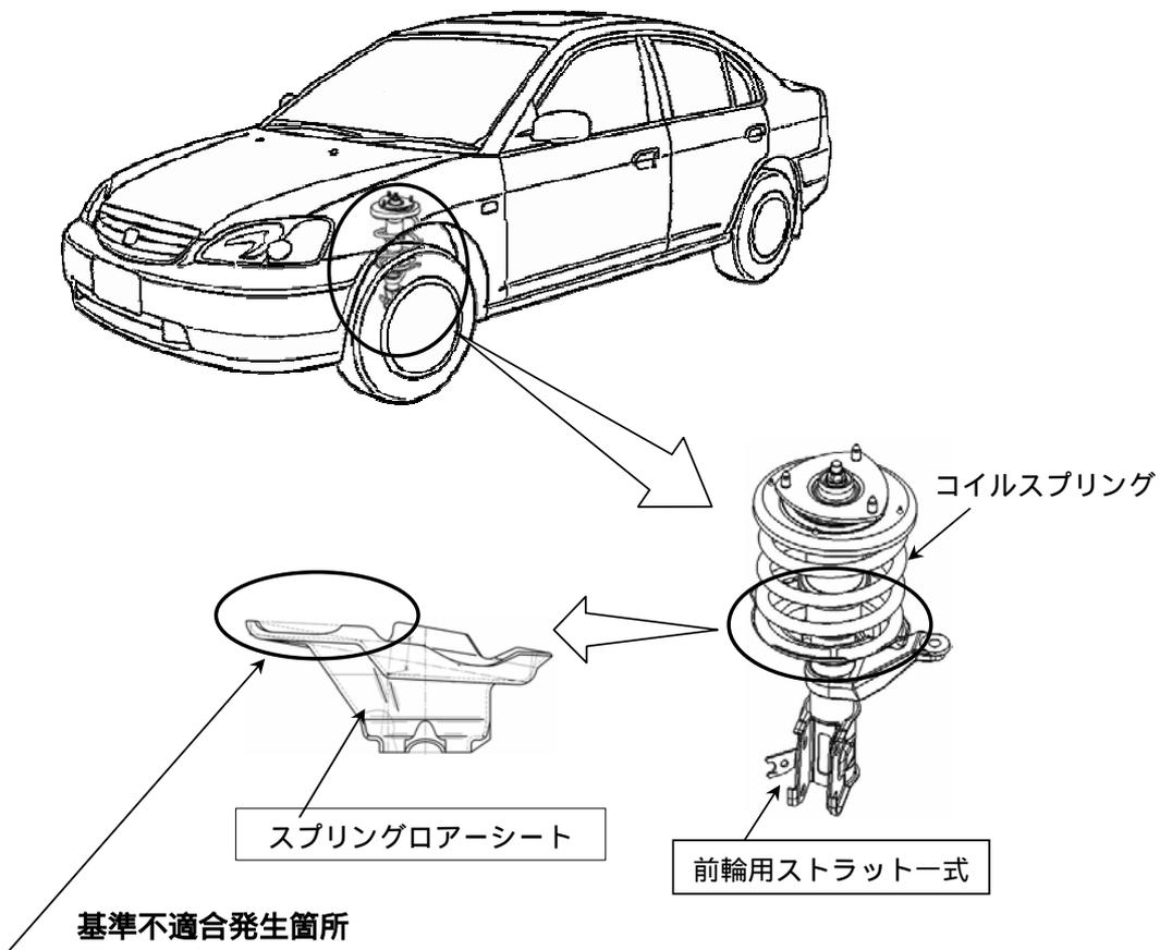
緩衝装置の前輪用コイルスプリングを保持するスプリングローシートの形状が不適切なため、当該スプリングとローシートの間に入った砂等によりスプリングの塗装が剥れて錆が発生するものがある。そのため、そのまま使用を続けると、融雪剤等により錆が進行してスプリングが折損し、最悪の場合、タイヤがバーストして走行不能となるおそれがある。
