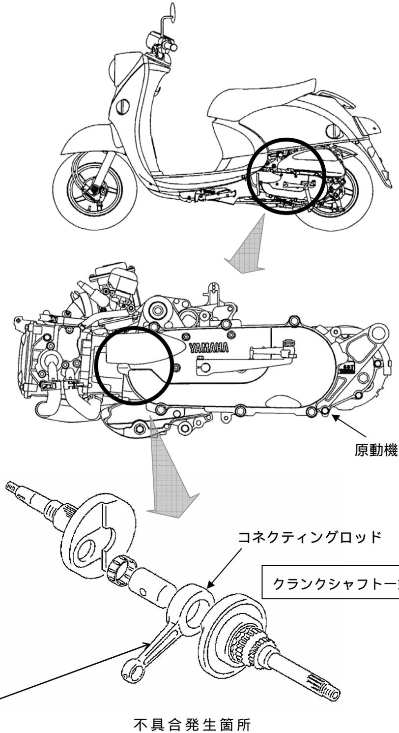
エンジンのコネクティングロッドの製造時の熱処理方法が不適切なため、当該コネクティングロッドの強度が不足しているものがある。そのため、そのまま使用を続けると、コネクティングロッドが破損し、エンジンが停止して再始動できなくなるおそれがある。
