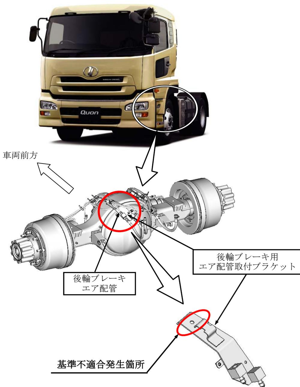
後輪ブレーキ用エア配管取付ブラケットの強度が不足しているため、走行時の路面入力等によって当該取付ブラケットに亀裂が発生するものがある。そのため、そのまま使用を続けると、当該取付ブラケットが折損し、最悪の場合、ブレーキエア配管が損傷してエアが漏れ制動力が低下するおそれがある。
