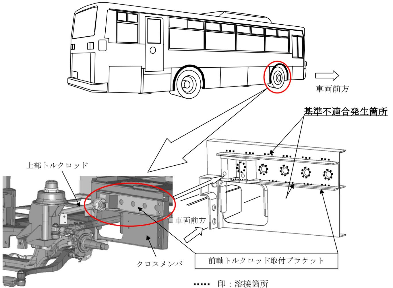
大型ノンステップバスにおいて、前軸トルクロッド取付ブラケットとクロスメンバの溶接箇所の一部が溶接されていないものがある。そのため、そのままの状態で使用を続けると、溶接が剥がれ、最悪の場合、ハンドル操作が不安定になるおそれがある。
