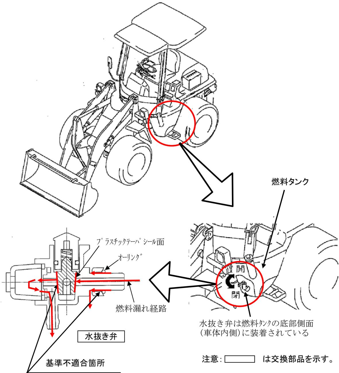
〔燃料タンク下部に装着されている水抜き弁の気密性が不足しているものがある。そのため、水抜き弁から燃料が漏れるおそれがある。〕
