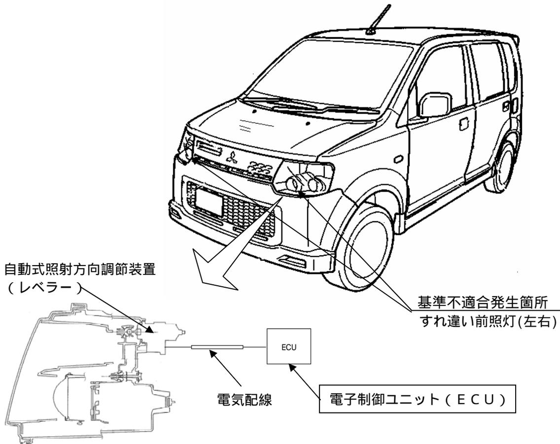
〔高輝度放電式 (H I D) 前照灯の自動式照射方向調節装置 (レベラー) において、電気回路が不適切なため、使用過程で回路接点に接触抵抗が発生した場合に、自動式照射方向調節装置 (レベラー) が正常に作動しないおそれがある。〕
