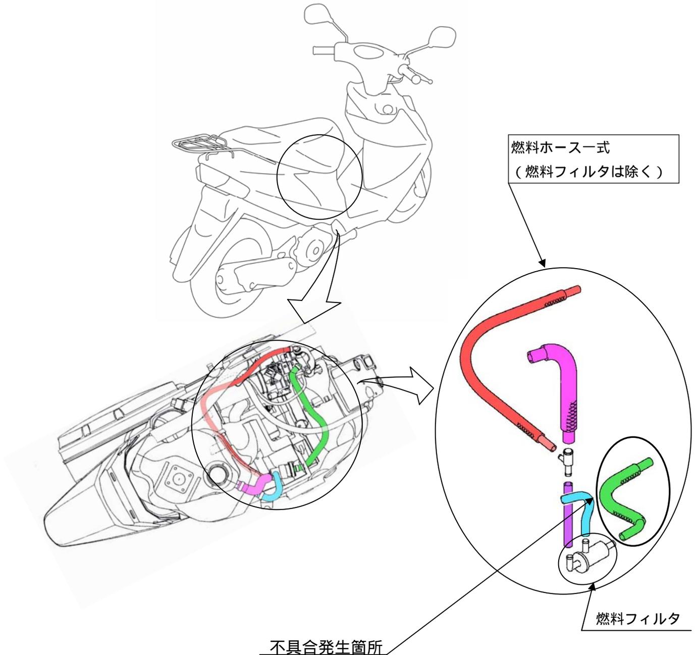
燃料ホースの製造工程において、異材料が混入したものがあるため、ホース表面に亀裂が発生する場合があります。そのため、そのまま使用を続けると、エンジンの揺動や振動により、亀裂が進行し、燃料が漏れるおそれがある。
