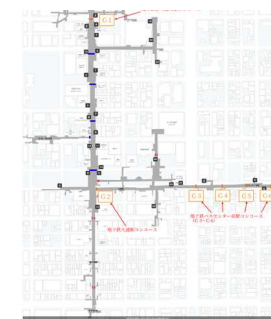
▼地下鉄コンコースの人流センサ設置
