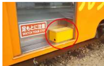
補助ステップ設置状況
