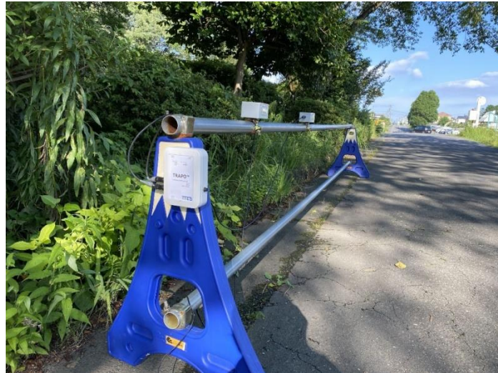
図 4-18 設置例(株式会社 TTES 交通カウンタ TRAPO)
