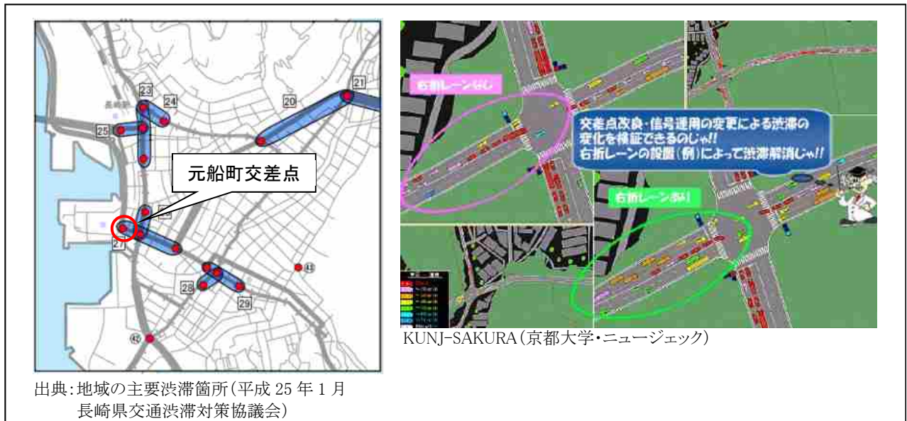
図 7.5.主要渋滞箇所図(左)と交通流シミュレーションの例(右)
