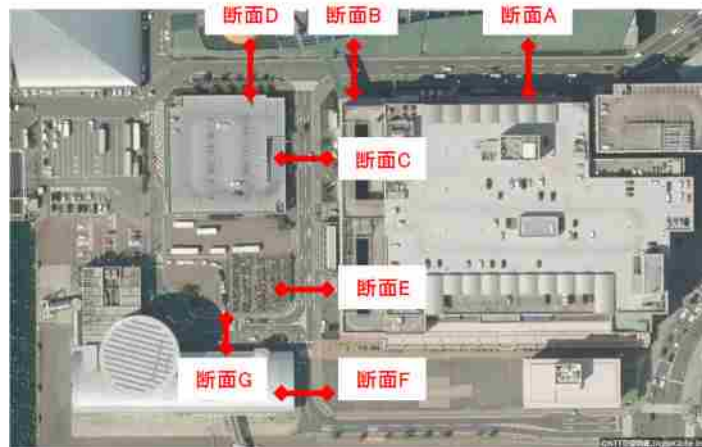
図 4.11.交通容量の算定断面
