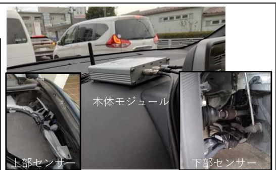
機器の設置状況
