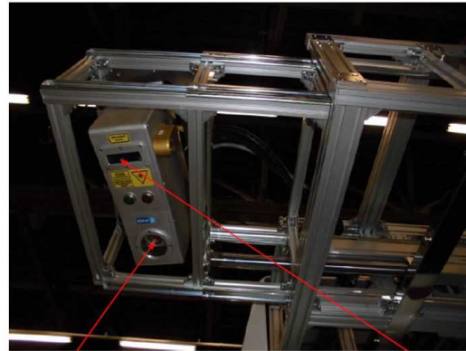
LCMS (路面画像の撮影と横断形状の計測) レーザプロファイラカメラ レーザライン照射部
