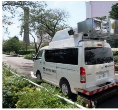
<掲載技術名> 複合探査車 (検出項目: ひび割れ率、わだち掘れ量、IRI)
