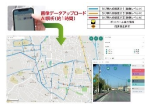
スマートフォンによる路面性状測定
