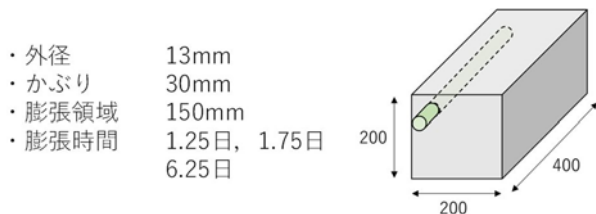
図-5.6.5 損傷度を評価する供試体
