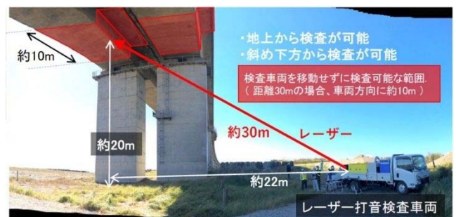
図-5.8.1 レーザー打音検査による橋梁点検イメージ
