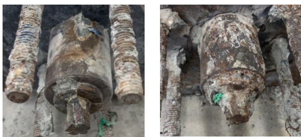
(a) 普通鋼F-5 (b) 普通鋼F-15 写真-16 普通鋼の定着具の腐食状況
