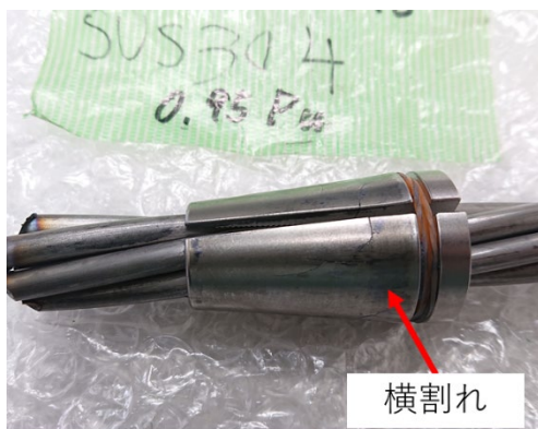
写真-6 ウェッジの横割れ
