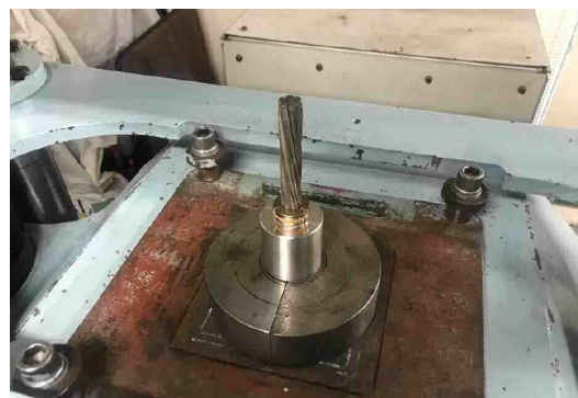
写真-5 定着具設置状況
