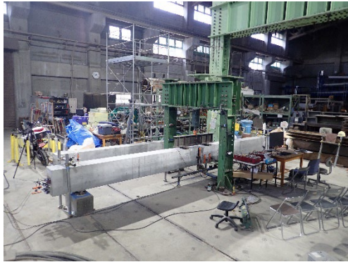
写真-13 載荷試験状況 (大型はり試験体)
