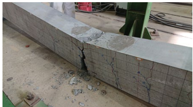
(b) SUSPC試験体 (鋼材破断)
