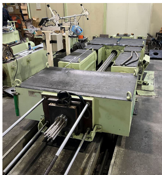
写真-9 マルチストランド定着具の定着性能確認試験状況
