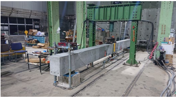
写真-2 プレテンションPC試験体載荷試験状況
