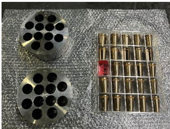
写真-10 試験前アンカーヘッド, ウェッジ
