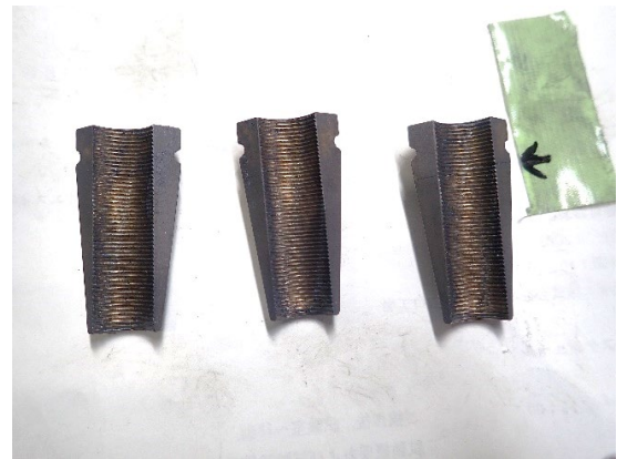
写真-11 ウェッジ亀裂状況 (供試体No.2)
