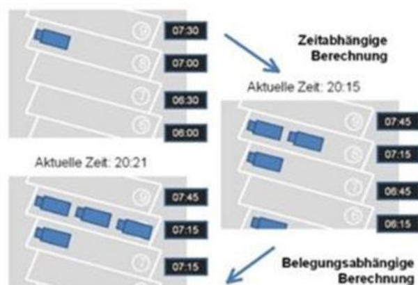
図 2.3-5 駐車レーンと事前に定められた出発時刻(出典:インタビュー調査資料)
