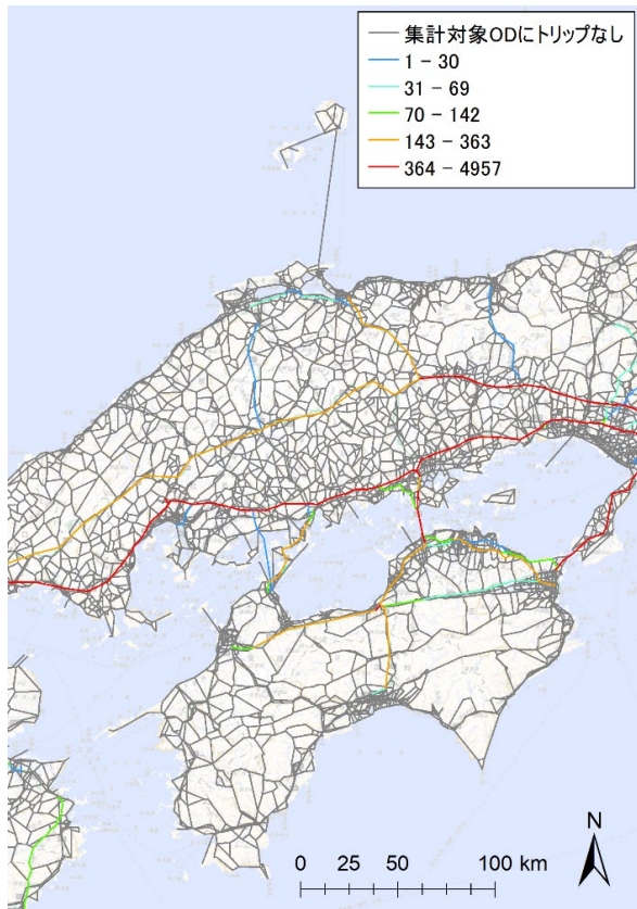
図 3.2-7 ダブル連結トラックや隊列走行への転換に適する大型貨物車の走行需要が高い区間 ※中国・四国およびその周辺. 左は最短時間距離解析, 右は最小一般化費用解析による結果
