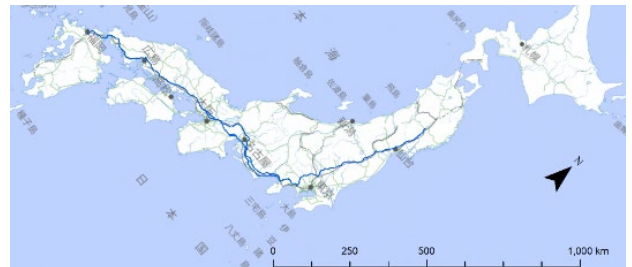
図 3.2-2 ②DRM をベースに作成したネットワークデータの例（解析時にダブル連結トラックが走行可能であったリンクのみ描画）
