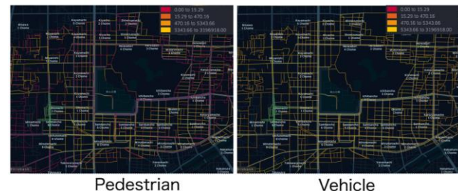
図-3.28 エージェント滞在数のリンク間相互情報量 (緑が設計対象リンク)
