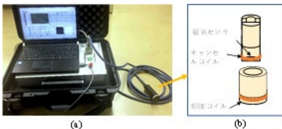
図 3.1-1 極低周波渦電流探傷検査装置(ELECT) (a) 装置本体, (b)磁気センサプローブ
