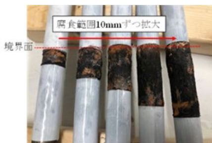
図 3.3-4 促進腐食試験体
