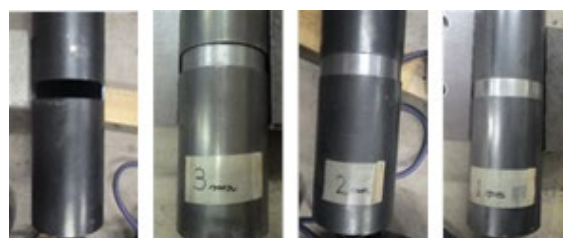
図 3.2-10 欠損を模擬した試験体
