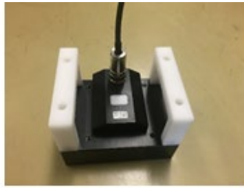
中型磁気センサプローブ 印加コイルサイズ：70×70 mm 2
