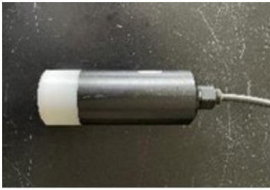
小型磁気センサプローブ 印加コイルサイズ：26 mmφ
