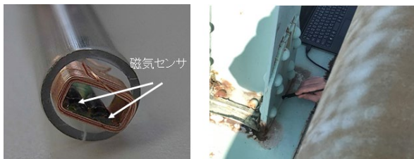
図 3.4-1 渦電流探傷法(ETC)の磁気センサプローブと検査風景
