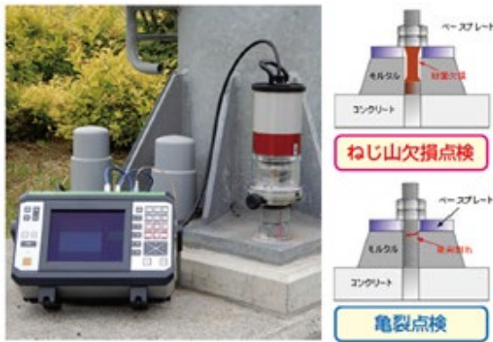
図2.3-1 アンカーボルト劣化判定システム SABHC
