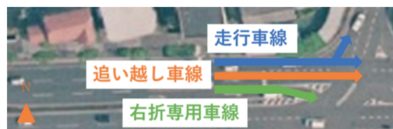
図-6.9 石立交差点の車線構成（改良前）
