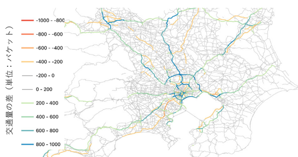
図1 全国規模シミュレーションによる高速道路料金変更時の交通量変化の計算（首都圏拡大）
