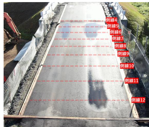
写真 4.30 CASE(2)における 10cm 降下後に生じた水たまりの様子 (左側：補強あり，右側：補強なし)
