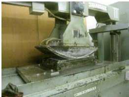
(e) ローラコンパクトで締固め
