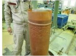
(b) キャップを取付け負圧により試料を自立安定 (二重メンブレン)
