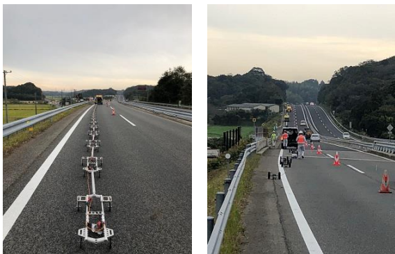
写真 4.5 ハイブリッド計測の測定状況(左:2次元表面波探査, 右:牽引式電気探査)
