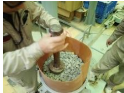
(a) モールド内側にメンブレンを装着し試料を投入 締固め(h=15cm)
