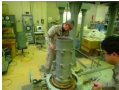
(a) モールド内側にメンブレンを装着し試料を投入 締固め(h=15cm)
