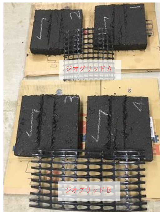
写真 4.23 試験後の供試体
