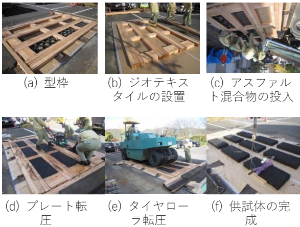
写真 4.16 供試体の製作状況
