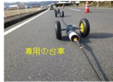
写真 2.4 牽引式電気探査用の台車(2輪車)
