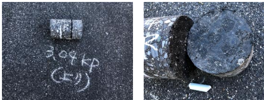
写真 4.15 瀝青安定処理層中間に敷設したジオグリッドのコア写真 (KP3.04)
