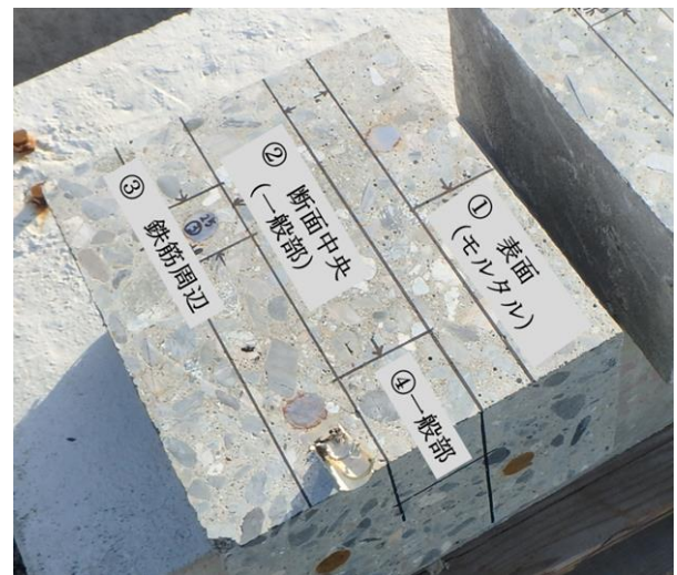
図 2-7 気泡間隔係数を計測する供試体と計測位置
