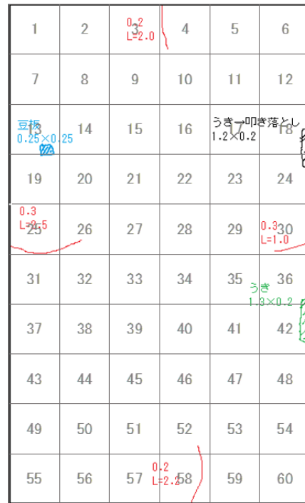
図 4-1 点検データに60分割の位置情報を与えた詳細分析手法
