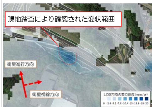
図-1 斜面崩壊範囲の現地踏査と衛星 SAR との比較
