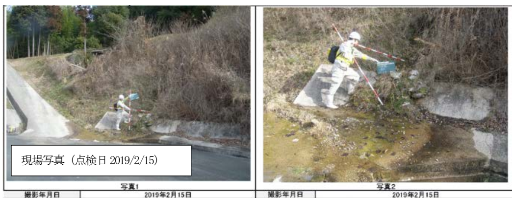
図-50 後方散乱係数を活用したのり面からの湧水箇所の検出結果(広島県世羅町)
