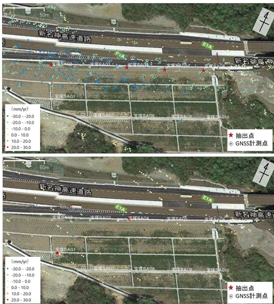
図 3.14 高盛土（宝塚北 SA）における解析結果（Google Earth を加工して作成） （上：X バンドデータ使用結果） （下：C バンドデータ使用結果）
