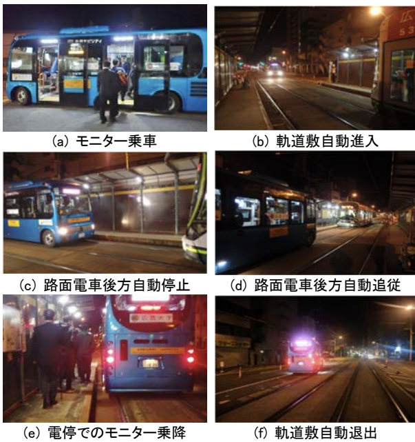
図 5-34 モニター試乗の工程写真
