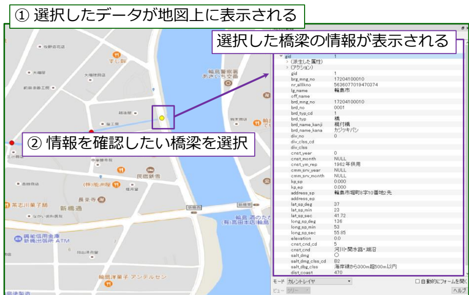
図 5.10 実稼働画面その3（施設の属性情報の取得：橋梁を例として）
