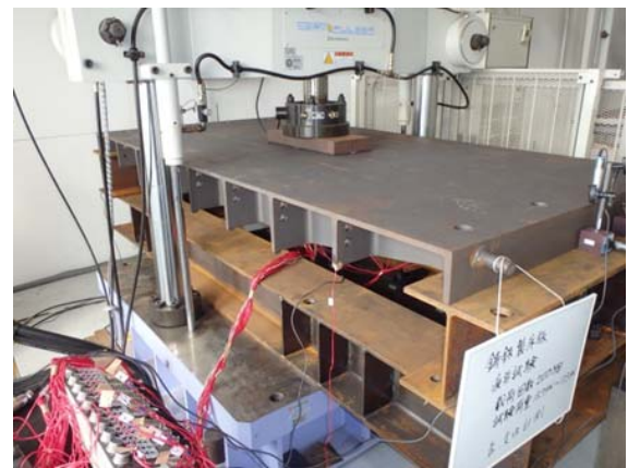
図5-10 定点繰返し载荷試験状況
