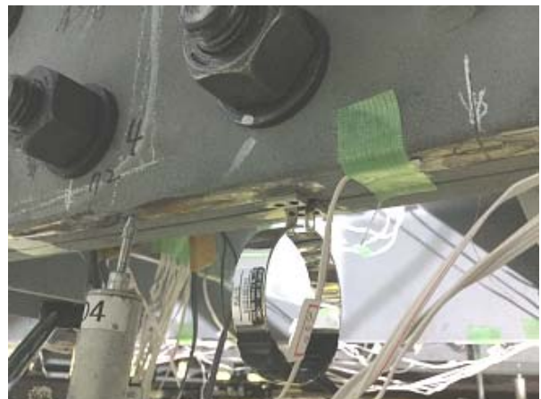
図5-27 現場継手部の測定機器設置状態
