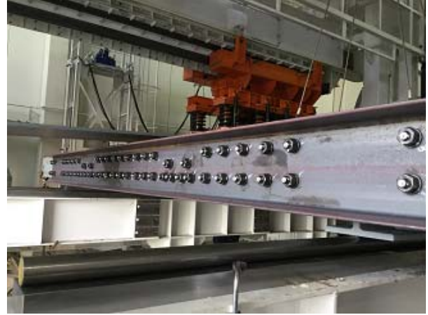
図 5-22 鑄鉄床版端部の補強
