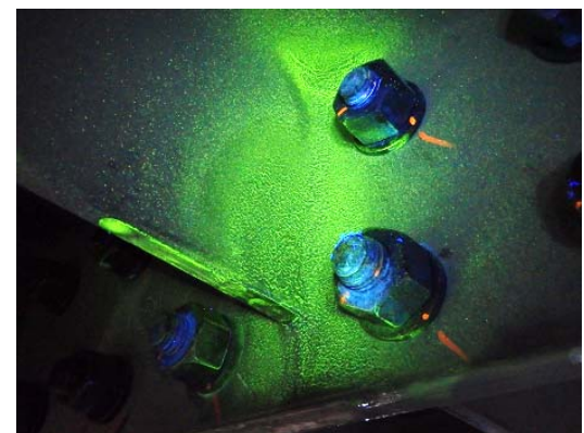
図5-32 磁粉探傷検査結果 (リブ交差部)
