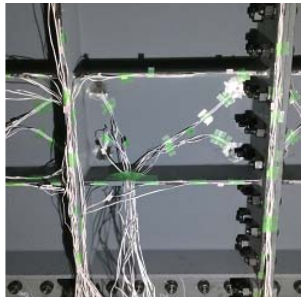
図5-26 デッキ下面の測定機器設置状態
