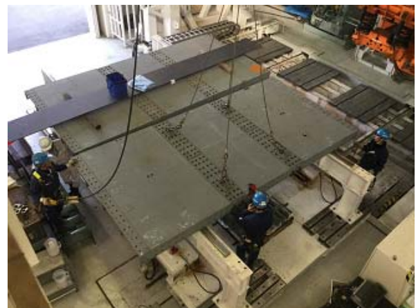
図5-20 輪荷重走行試験用試験体（設置中）
