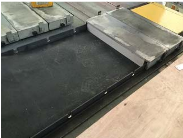
図5-24 輪荷重載荷部位（設置途中）
