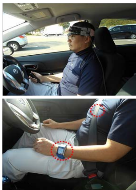
図2-2 高速道路指定区間での生体反応データ計測機器装着状況
