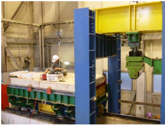
写真-2 輪荷重走行試験機 (日本大学)
