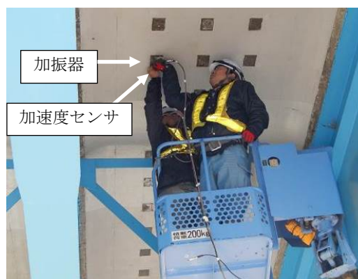
写真-20 C 橋の測定状況
