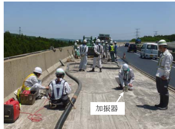
写真-5 道路橋 RC 床版の現場試験状況
