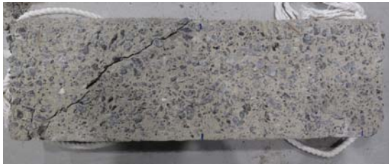
写真-11 Sa(85) 供試体の破壊状況
