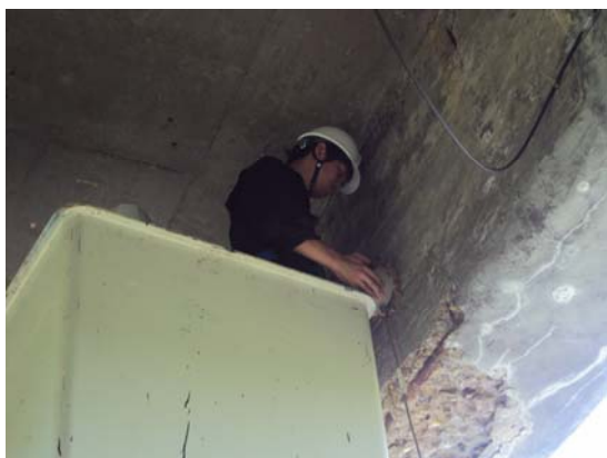
写真-14 主桁の局所振動試験の状況
