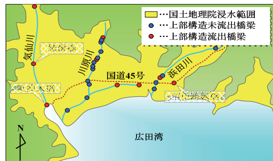
図—5 陸前高田全体の橋梁被害と浸水範囲
