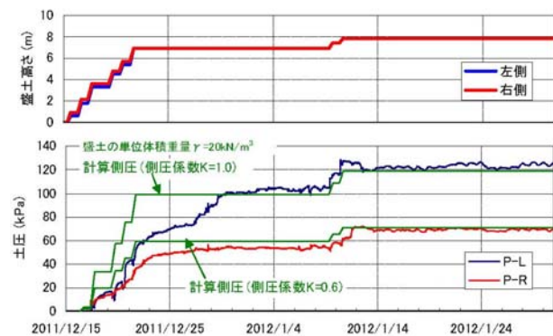
図4-18 サイドウォールに作用する土圧計測結果
