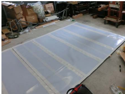
(b) 盛土側のテフロンシート
