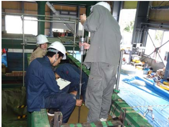
写真3-7 簡易動的コーン貫入試験
