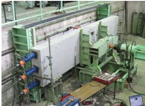
図-15 継手部の曲げ試験
