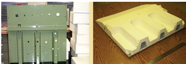
図2-16 欠陥が施された燃料タンクと同じ構造のパネル（左図）と発砲断熱材でコーティングされた試験体（右図）
