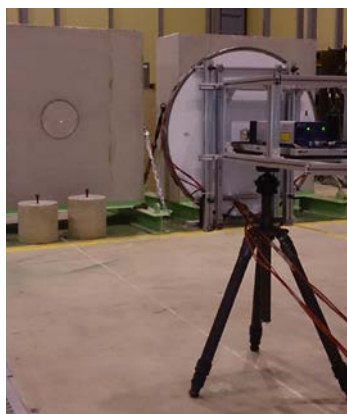
Fig.5.10 強力超音波音源によるコンクリート欠陥探査実
