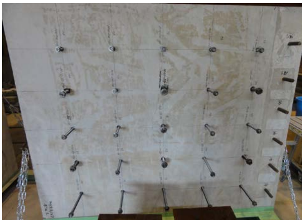
Fig.3.13 アンカーボルト供試体の外観
