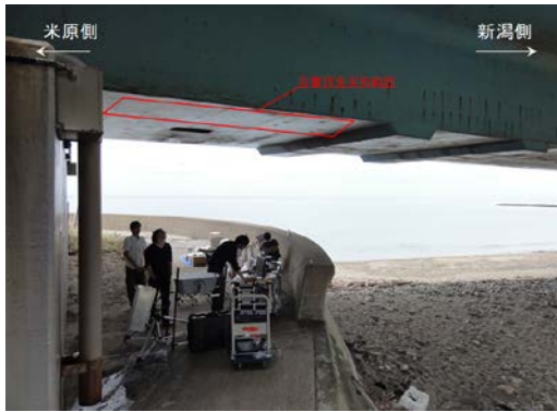
Photo. 4.4 PC箱桁橋探査時のセットアップ
