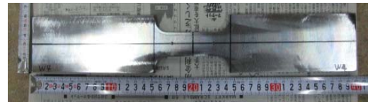
写真 4-7 腐食腹板から採取し加工研磨した腐食材料試験片
