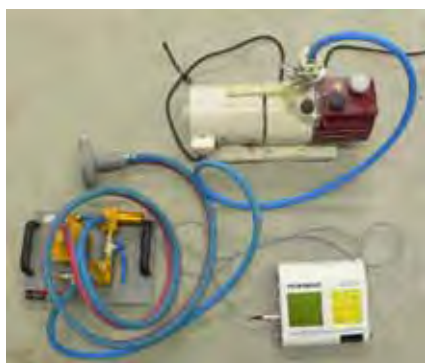
写真-2.1 Torrent 透気試験
