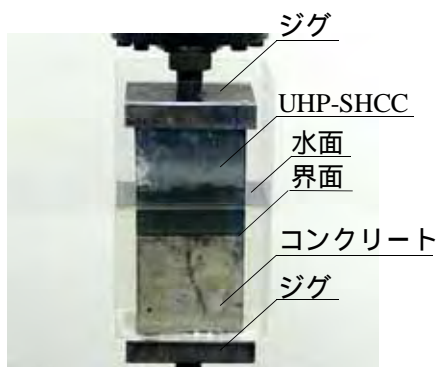
写真-3.3 載荷状況（水中試験）
