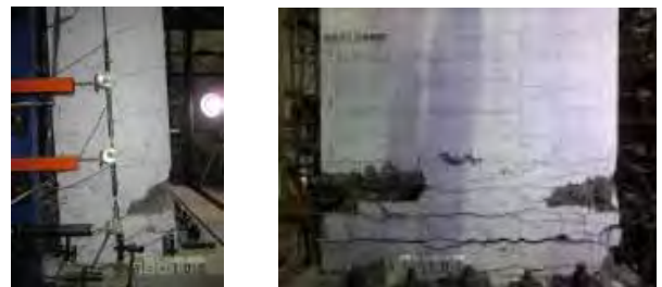
写真-5.6 初期載荷時の損傷状況
