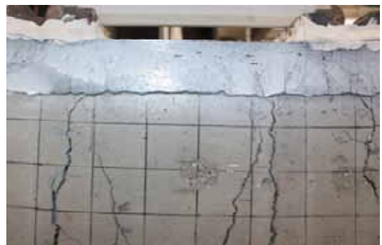
写真-3.6 UHP-SHCC 増厚供試体の終局時
