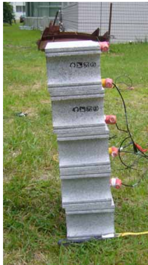
図4.2 5段積みコンクリートブロック
