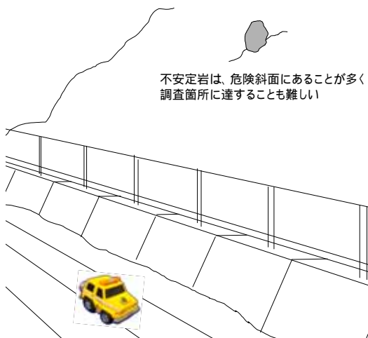
図1.1 道路斜面上の不安定岩(イメージ)
