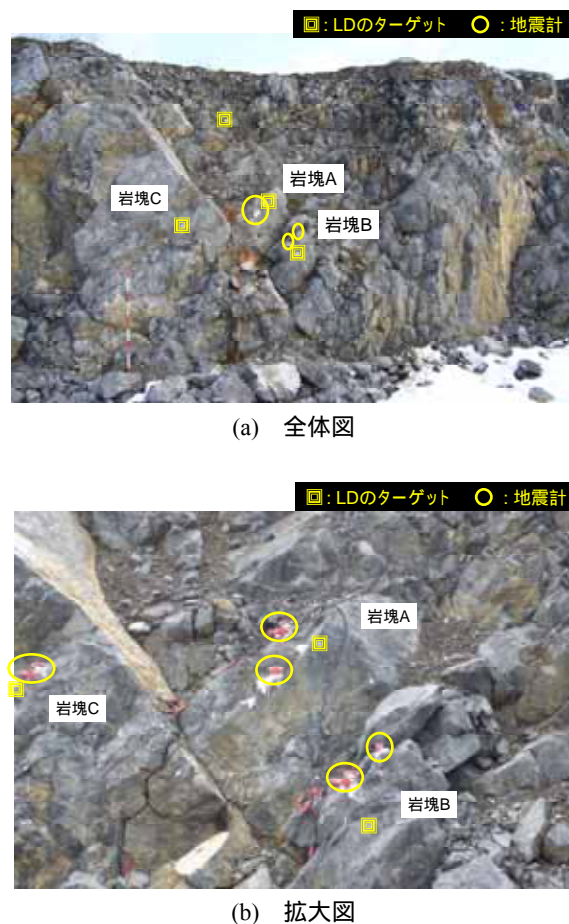
図 3.20 ターゲット・地震計の設置箇所
