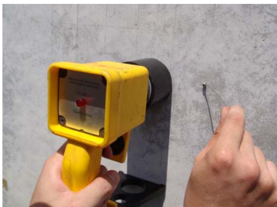
図-2.10 衝撃弾性波法の計測状況
