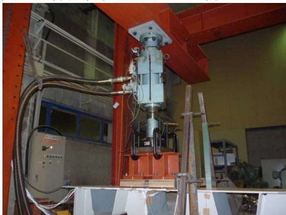
図 4.25 定点荷重疲労試験機
