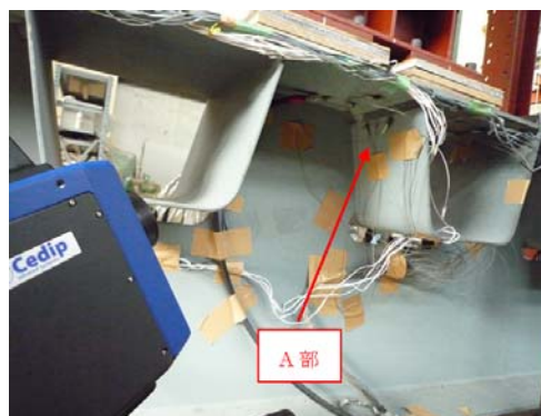
図4.28 赤外線計測の状況
