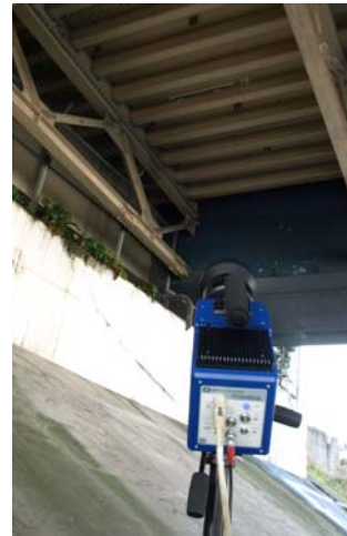
図4.17 遠隔からの赤外線計測
