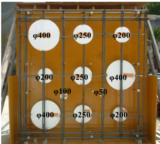
図-2.8 人工欠陥の配置状況の一例
