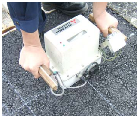
図-2.11 EMH法の計測状況
