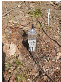
写真-5.2 テンシオメータ設置状況
