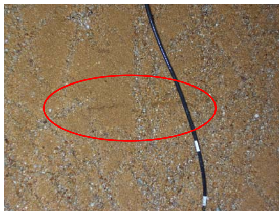
写真-3.5 崩壊状況（注水 32 分後）
