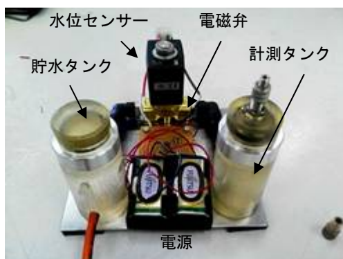
写真-4.4 電磁弁を用いた注水システム概略図
