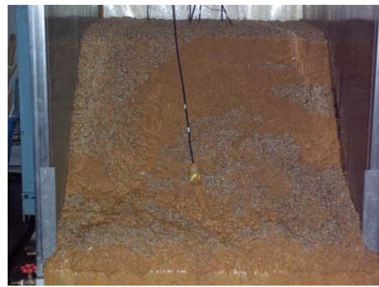
写真-3.7 崩壊状況（注水 147 分後）
