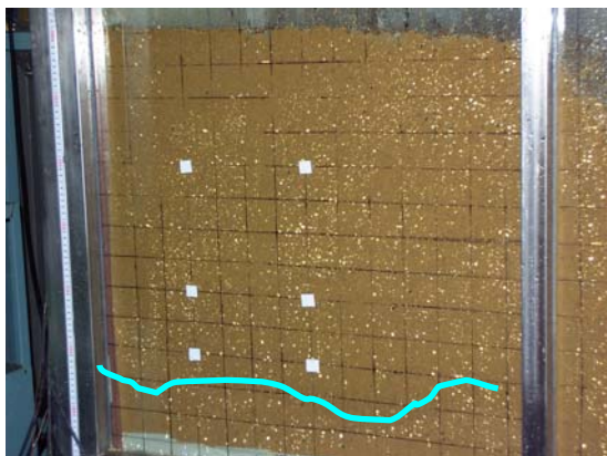
写真-3.4 浸透状況（注水 120 分後）
