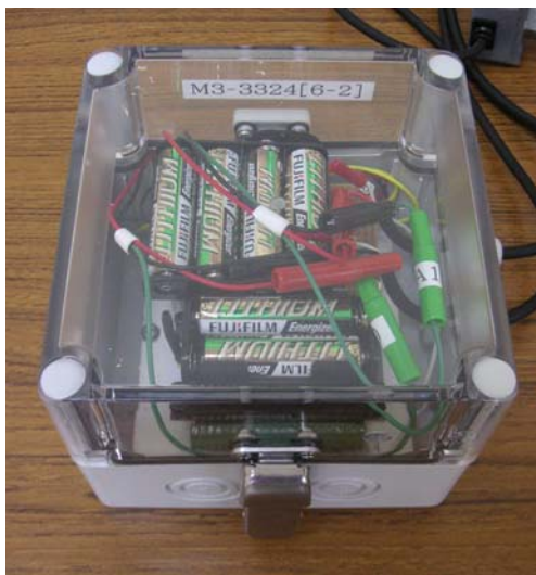
写真-4.6 ハードウェアを耐候性ボックスに収めた状況
