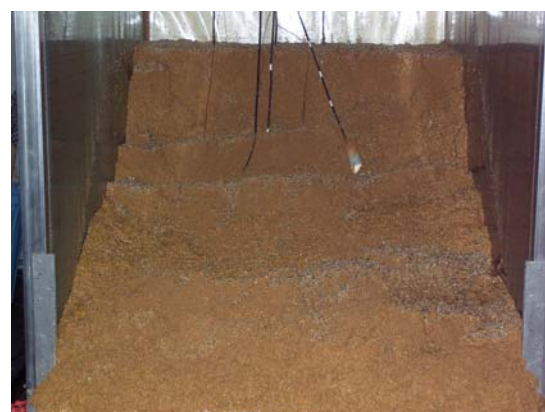
写真-3.8 崩壊状況（注水 165 分後）
