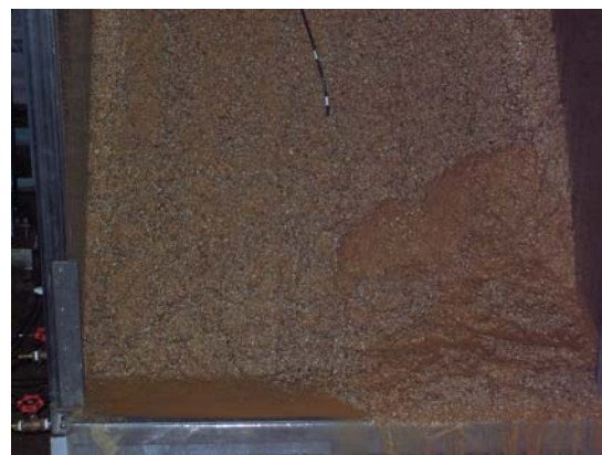
写真-3.6 崩壊状況（注水 115 分後）
