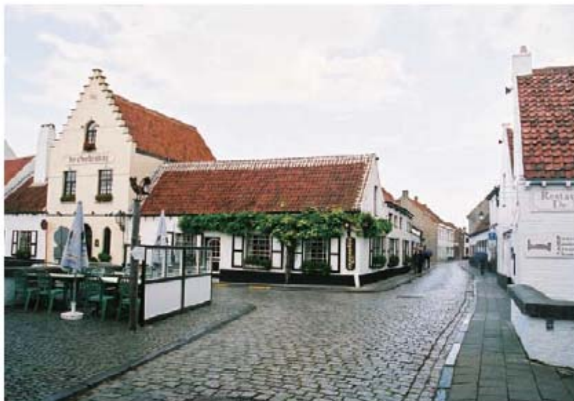
道路幅員が変化すると、人間には特段の支障はないが、車にはプレッシャーを与える。
