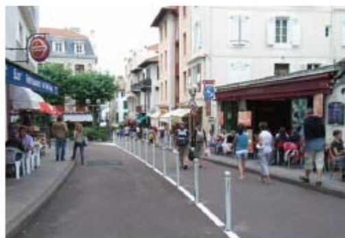
センターラインに車止めを設置し、車にプレッシャーをかけた道路。
