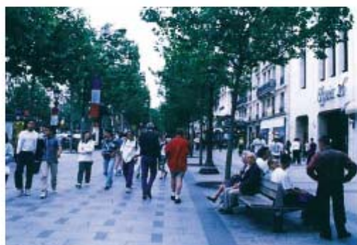
パリ、シャンゼリゼ。歩道中央の施設帯の前に太い濃色の舗装を入れ、休憩スペースを分節している。
