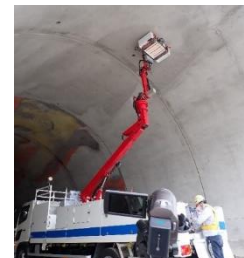
レーザー打音による変状の把握
