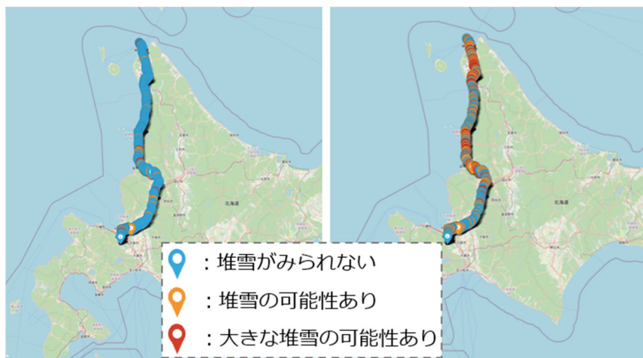
図1-19 特急わっかない号で記録した車両前方映像からの堆雪の観測
