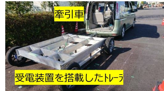
写真1-3 走行中・停車中給電 の様子
