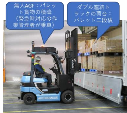
図-3-4 ダブル連結トラックを用いた自動荷役の実証実験（撮影：兵藤）
