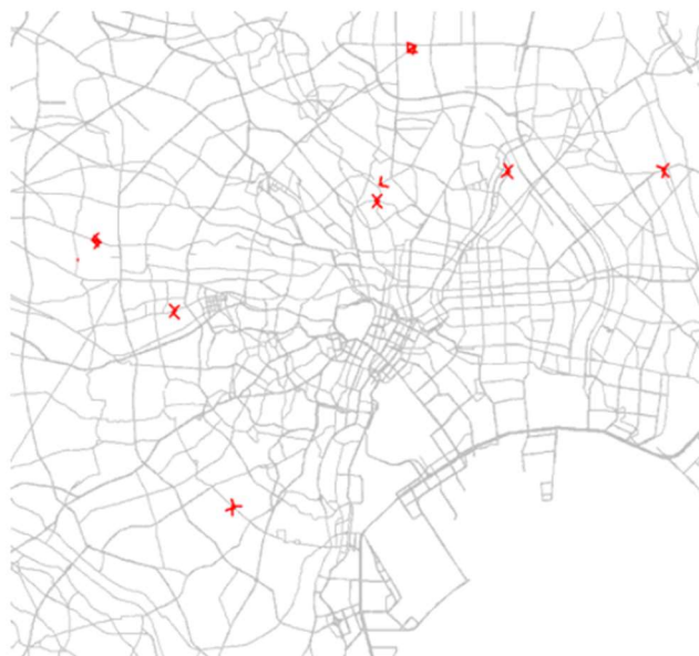
図4-1-7 火災による通行止めの設定箇所
